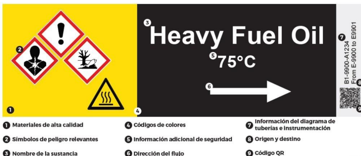
Exemple d'etiqueta de canonada en compliment de la ISO 20560
